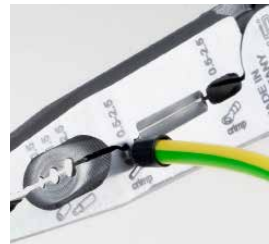
4 Crimpen von Aderendhülsen 4 crimping of ferrules
