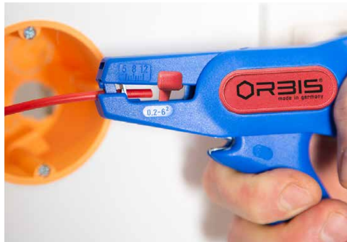
abisolieren wire stripper
