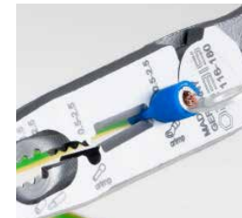
6 Crimpen von Kabelschuhen 6 crimping of cable connectors
